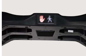
金属を感知するとストップの表示が点灯
